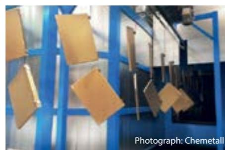
Rezultati preizkusov kažejo, da je železovo fosfatiranje ustrezen način priprave za hladno valjano jeklo do kategorije korozivnosti C3, vendar se ne sme uporabljati v zelo
