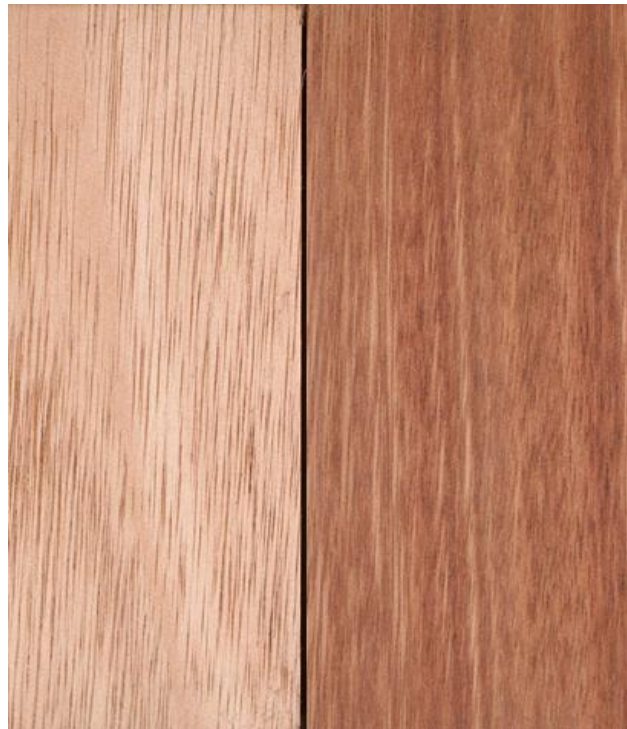
Holzoberfläche von Eukalyptus (Radialschnitt)
