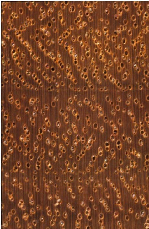
Makroskopischer Querschnitt von Eukalyptus (10-fache Lupenvergrößerung)
