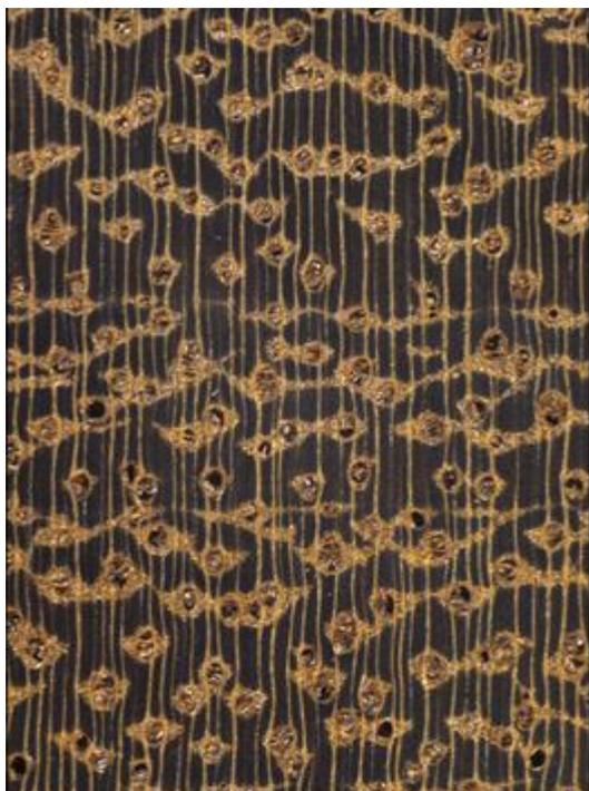
Макроскопический поперечный разрез ироко
