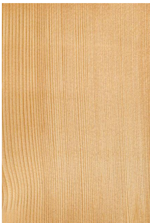
Поверхность древесины ели (радиальный разрез)
