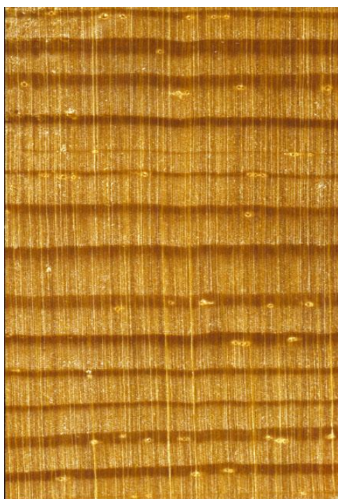
Макроскопический поперечный разрез ели (линзы 10-кратного увеличения)
