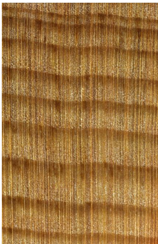
Макроскопический поперечный разрез хемлока (линзы 10-кратного увеличения)
