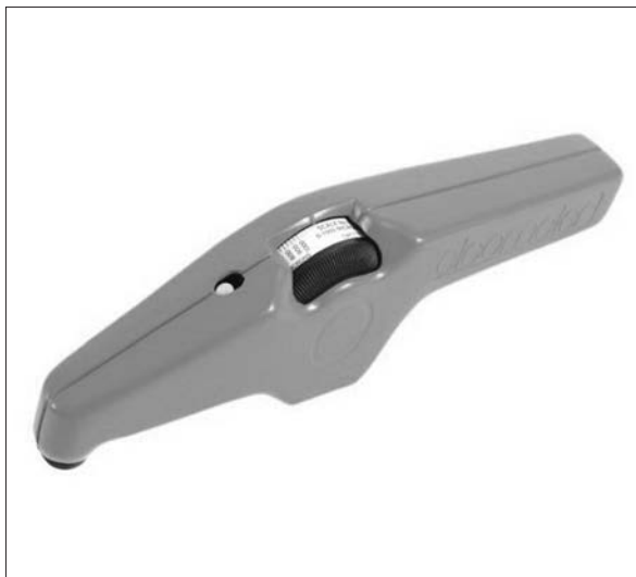
Рис. 7.12б Толщиномер для пленки, действующий по принципу магнитного притяжения, используется на взрывоопасных объектах, таких как нефтяные буровые платформы и другие аналогичные объекты. Данный толщиномер также известен под названием "банан" и подходит для проведения замеров в соответствии со стандартами ISO 2178 и 2808-7A.
