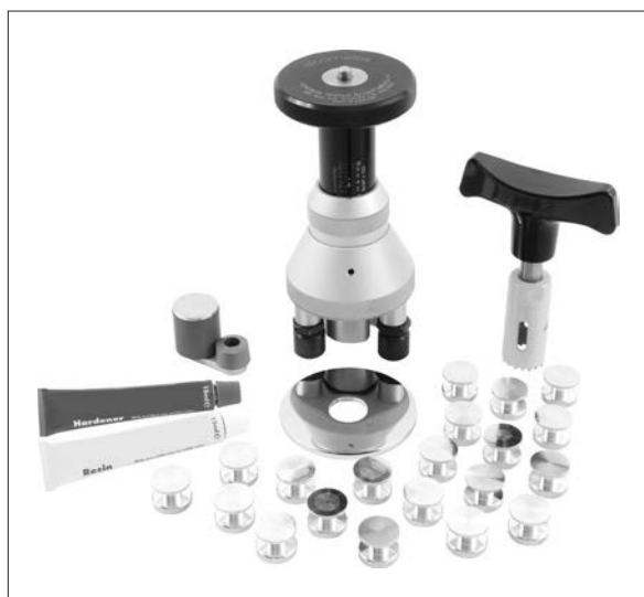
Рисунок 8.3 Прибор для измерения адгезии пленки методом отрыва ISO 4624 и ISO 16276-1.
