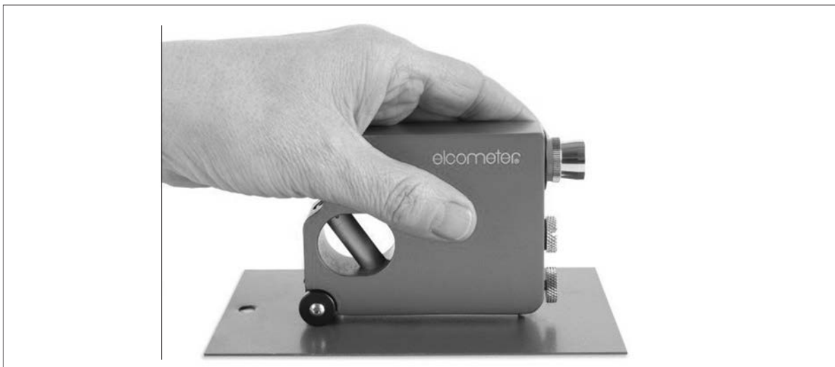
Рис. 7.13а Режущий инструмент для выполнения V-образного надреза используется для проведения замеров в соответствии со стандартом ISO 2808-6B.
