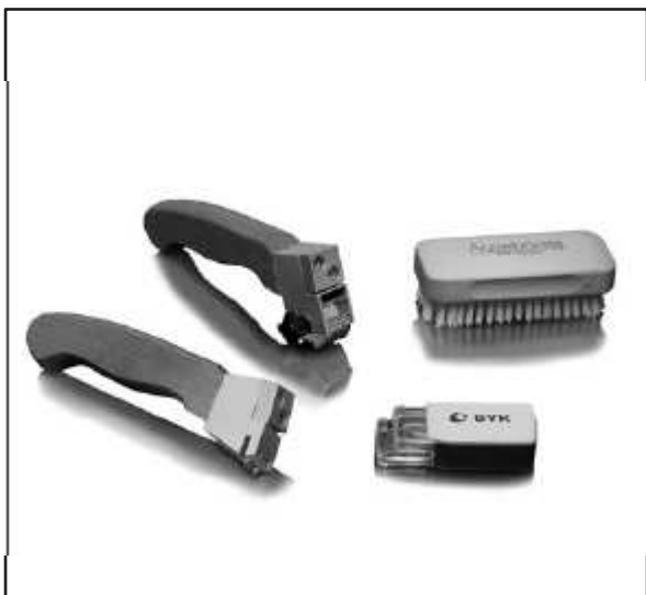
Fotografia 8.4 Przecinak stosowany przy pomiarze odporności warstwy na odrywanie zgodny z normą ISO 2409
