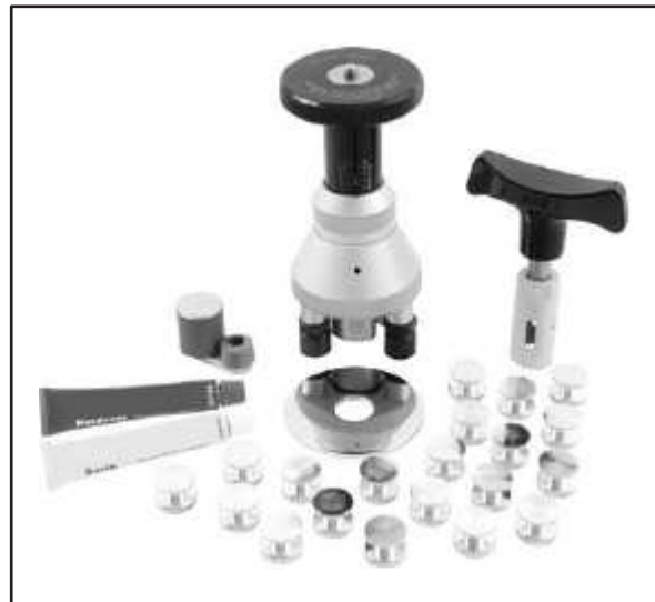
Fotografia 8.3 Próbnik do pomiaru przyczepności warstwy metodą „pull-off” [odrywania] zgodny z normami ISO 4624 oraz ISO 16276-1.
