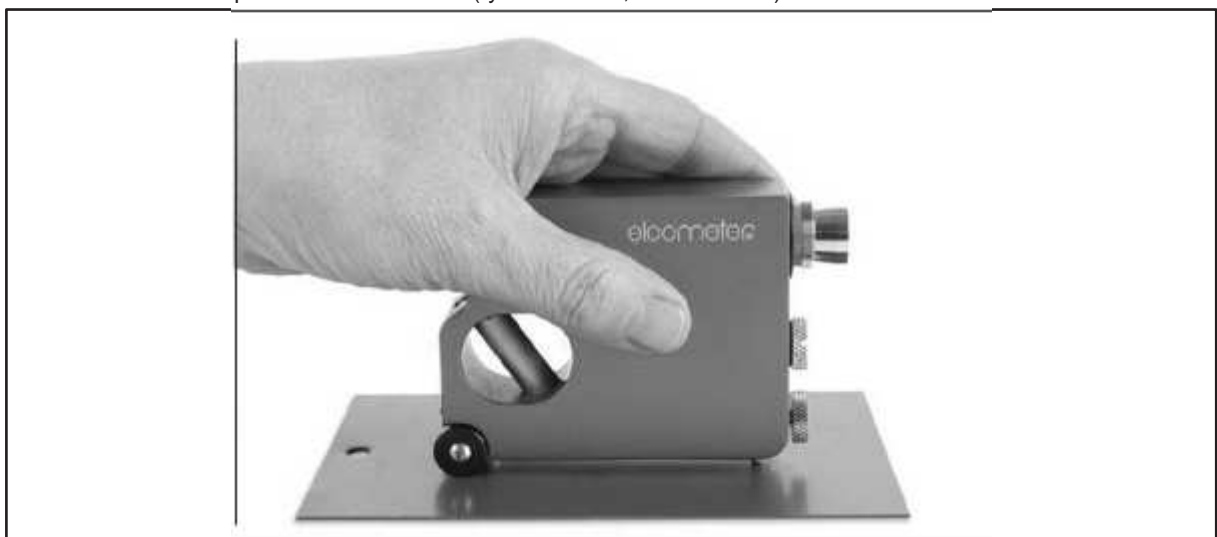
Rysunek 7.13a: Nóż tnący do nacięcia w kształcie V jest używany do pomiarów wykonywanych zgodnie z normą ISO 2808-6B.
