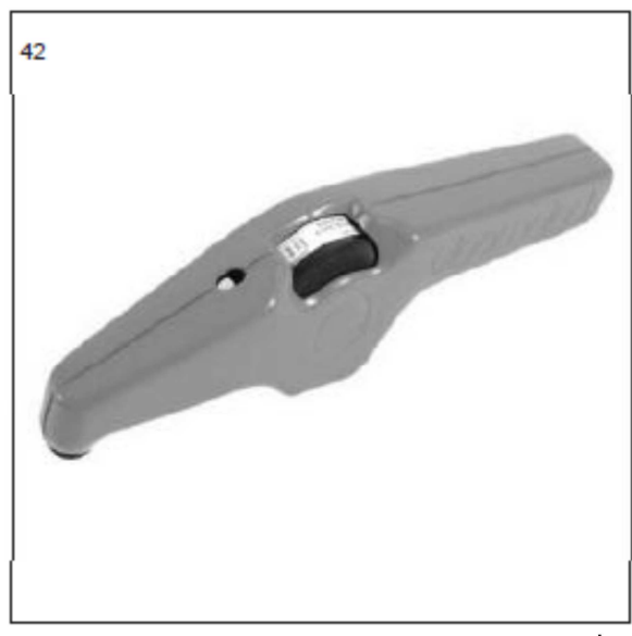
Rysunek 7.12b: Przyrząd do pomiaru grubości filmu wykorzystujący zjawisko odpychania magnetycznego jest używany w strefach zagrożonych wybuchem, jak np. platformy wiertnicze, rafinerie i inne podobne obiekty. Miernik jest również znany jako "banan" i jest odpowiedni do pomiarów prowadzonych zgodnie z normą ISO 2178 i ISO 2808-7A.
