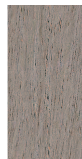
Drewno tekowe z nałożonym standardowym, rozpuszczalnikowym olejem do drewna Narażone na intensywne działanie promieni UV i wilgotność
