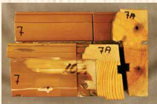
Trattamento a quattro mani con preservante fondo per il legno
