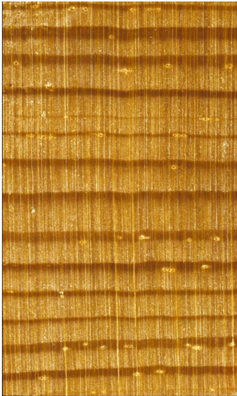
Sezione trasversale macroscopica del peccio (Lente di ingrandimento x10)
