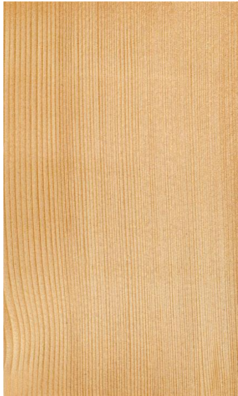
Superficie di legno del peccio (sezione radiale)
