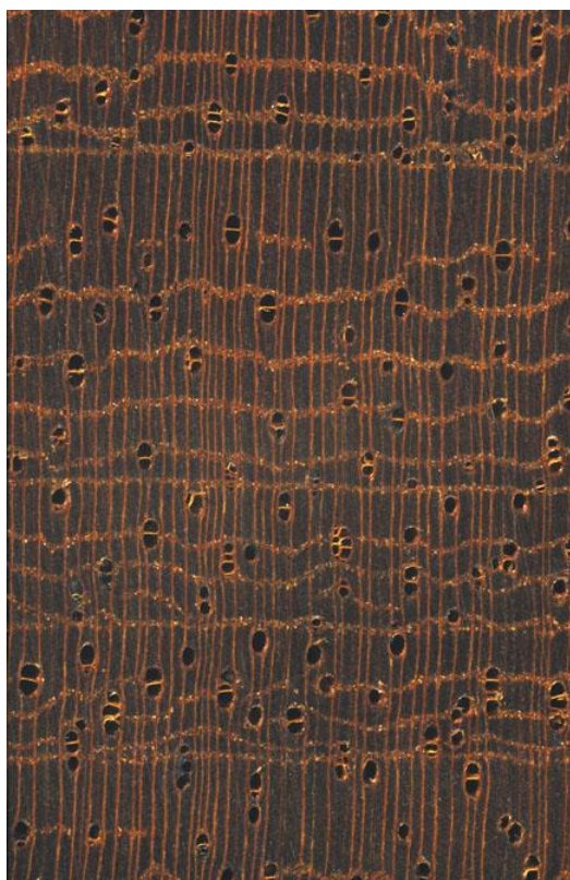
Sezione trasversale macroscopica di Sipo (Lente di ingrandimento x10)
