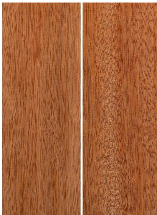
Superficie di legno di Bintangor (sezione radiale)
