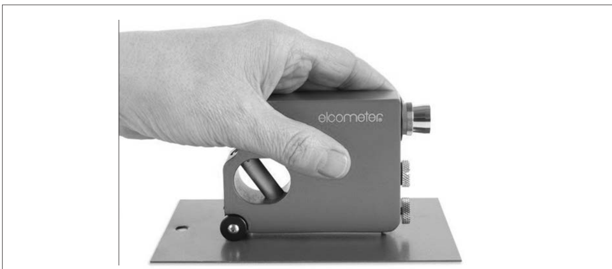
Kuva 7.13a Kiilauran leikkaavaa kalvonpaksuusmittaria käytetään ISO 2808-6B mukaiseen testaukseen.
