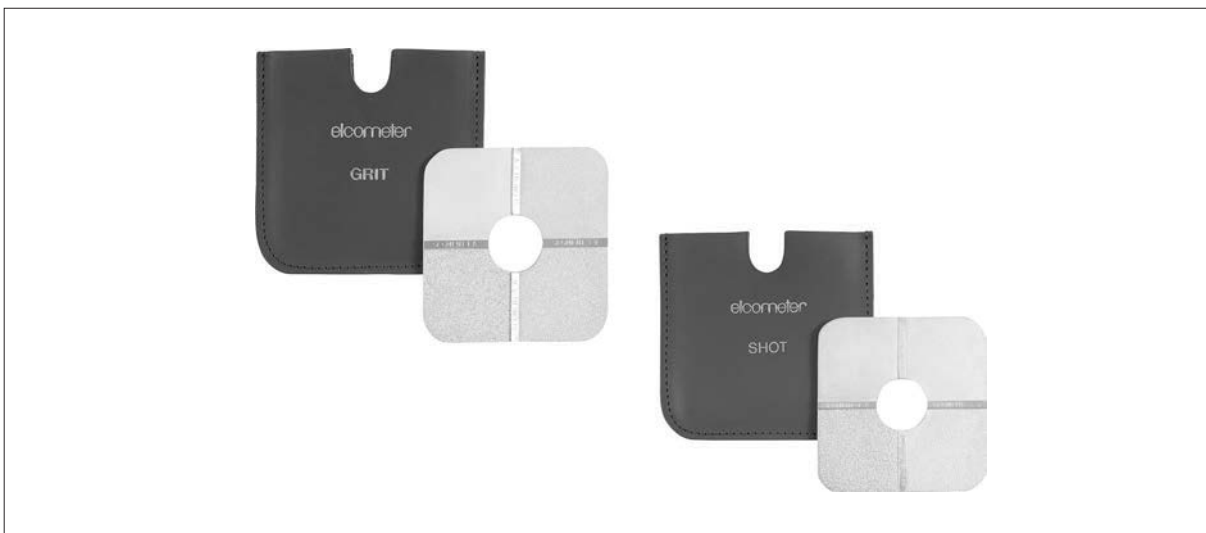
Kuva 4.1 ISO-pintaprofiilivertailukappaleet ISO 8503-1 ja ISO 8503-2 standardin mukaiseen testaukseen.
