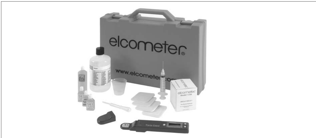
Kuva 8.1 Suolapitoisuuden mittauslaitteet, standardien ISO 8502-6 ja ISO 8502-9 mukaiseen testaukseen.
