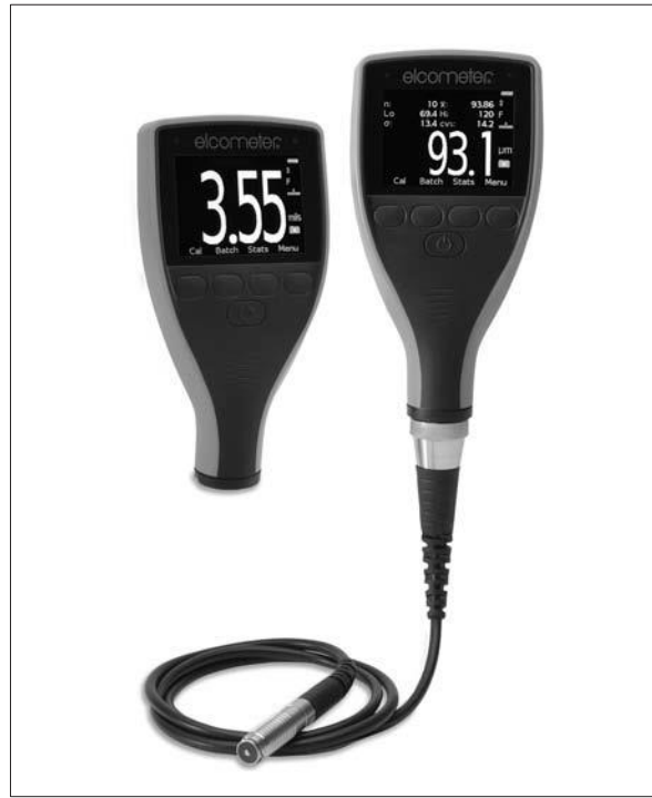
Joonis 7.12a Kuivikihi paksuse mõõturit kasutatakse testimiseks vastavalt standarditele ISO 1461, ISO 19840, ISO 2063, ISO 2360, ISO 2808-7C, ISO 2808-7D ja ISO 2808-12.
