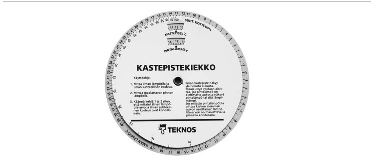
Joonis 7.9 Kastepunkti määramise ketas
