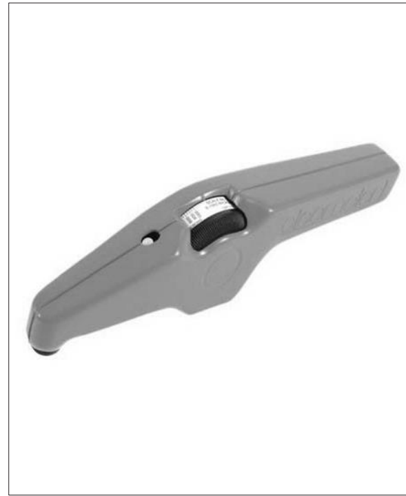
Joonis 7.12b Püsimagnetil põhinev äratõmbepõhimõttel töötav mõõtmisseade, mida kasutatakse plahvatusohtlikele objektidel nagu naftaplavvormidel, töökodades vms. Mõõturit kutsutakse ka "banaaniks" ning seda kasutatakse testimiseks vastavalt standarditele ISO 2178 ja ISO 2808-7A.
