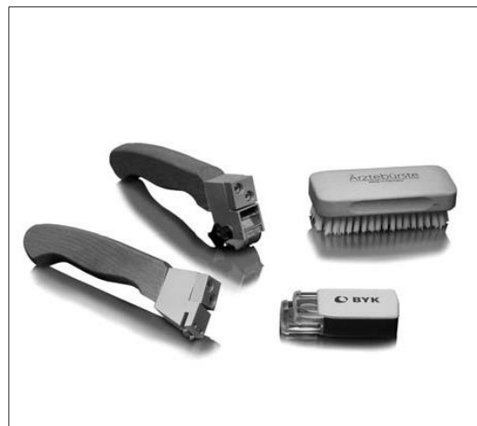
Joonis 8.4 Värvikihi nakkuvuse mõõtmine ristlõigetega vastavalt standardile ISO 2409.
