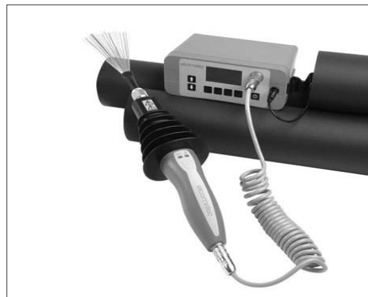
Joonis 8.2 Poorsuskontrolli seade, standardi ISO 2746 kohaseks testimiseks.
