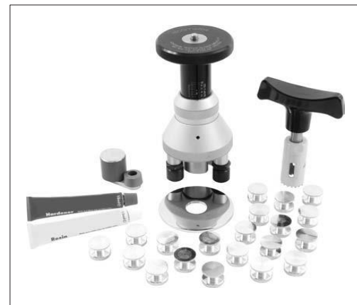
Joonis 8.3 Adhesiooni mõõtja, millega kontrollitakse värvikihi nakkuvust nn tõmbetestiga vastavalt standarditele ISO 4624 ja ISO 16276-1.
