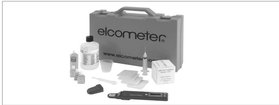
Joonis 8.1 Soolasisalduse mõõtmise seadmed, standardite ISO 8502-6 ja ISO 8502-9 kohaseks testimiseks.
