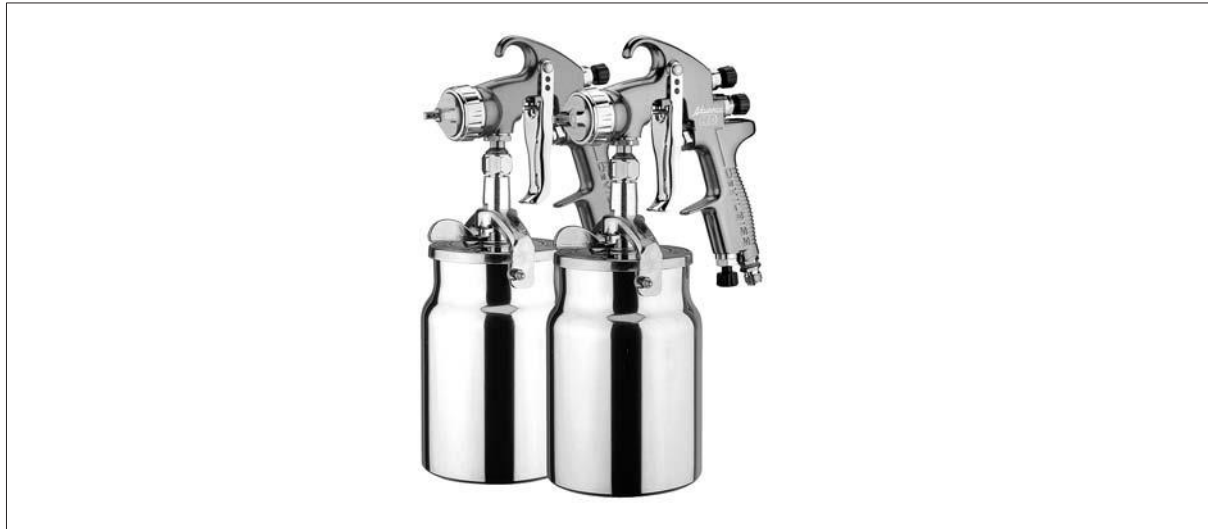
Joonis 7.1 Värvipüstolid ehk madalsurvepihustid
