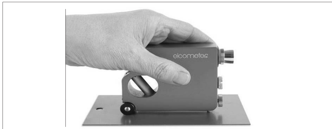
Joonis 7.13a Lõiketeraga varustatud kihipaksuse mõõturit kasutatakse ISO 2808-6B kohaseks testimiseks.
