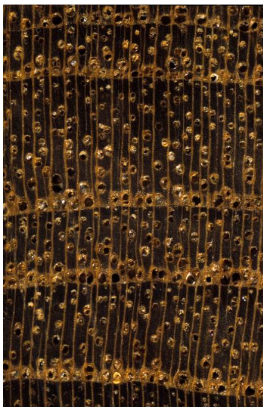
Makroskopisk tværsnit af Teak (10x forstørrelse)
