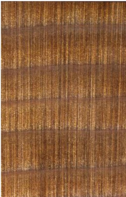
Makroskopischer Querschnitt von Western Red Cedar (10-fache Lupenvergrößerung)
