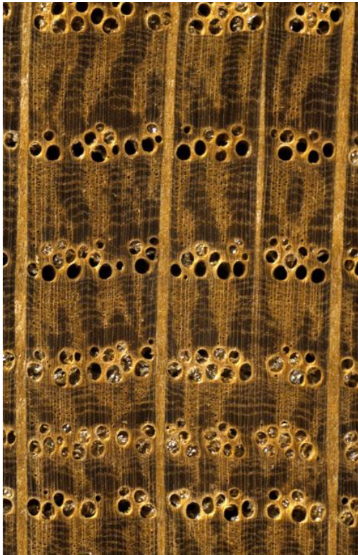
Makroskopischer Querschnitt von Weißeiche (10-fache Lupenvergrößerung)
