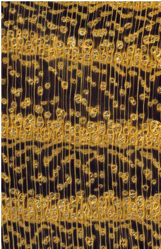
Makroskopischer Querschnitt von Robinie (10-fache Lupenvergrößerung)
