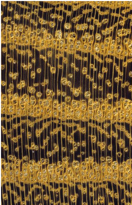
Makroskopischer Querschnitt von Robinie (10-fache Lupenvergrößerung)
