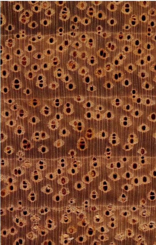
Makroskopischer Querschnitt von Merbau
