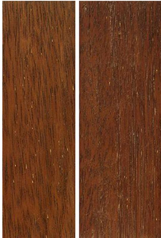
Holzoberfläche von Merbau (Radialschnitt)
