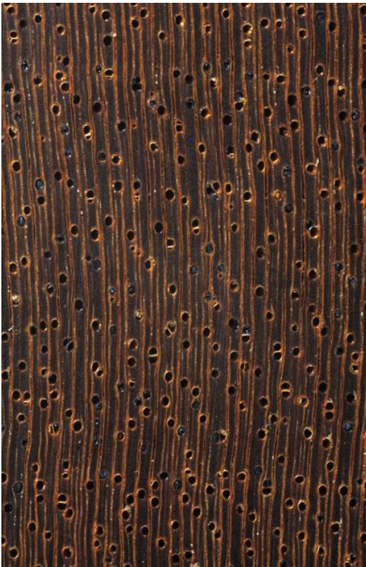
Makroskopischer Querschnitt von Khaya (10-fache Lupenvergrößerung)
