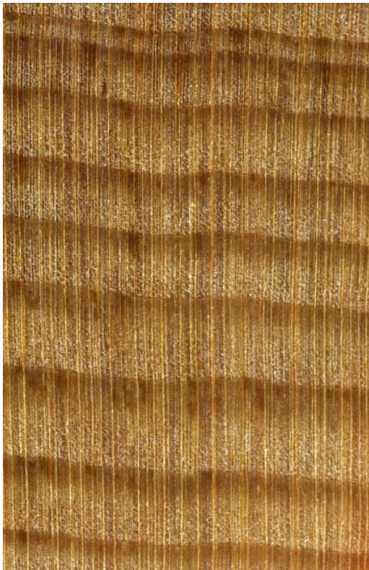
Makroskopischer Querschnitt von Hemlock (10-fache Lupenvergrößerung)
