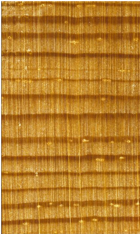
Makroskopischer Querschnitt von Fichte (10-fache Lupenvergrößerung)
