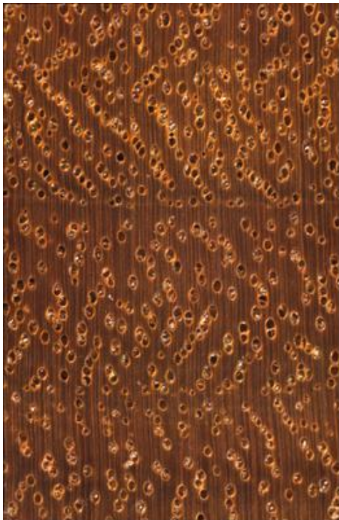
Makroskopischer Querschnitt von Eukalyptus (10-fache Lupenvergrößerung)
