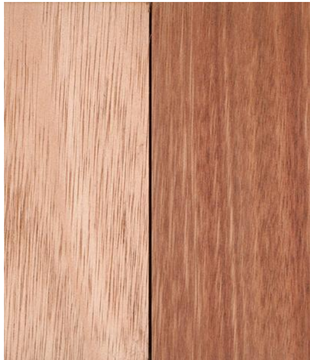
Holzoberfläche von Eukalyptus (Radialschnitt)
