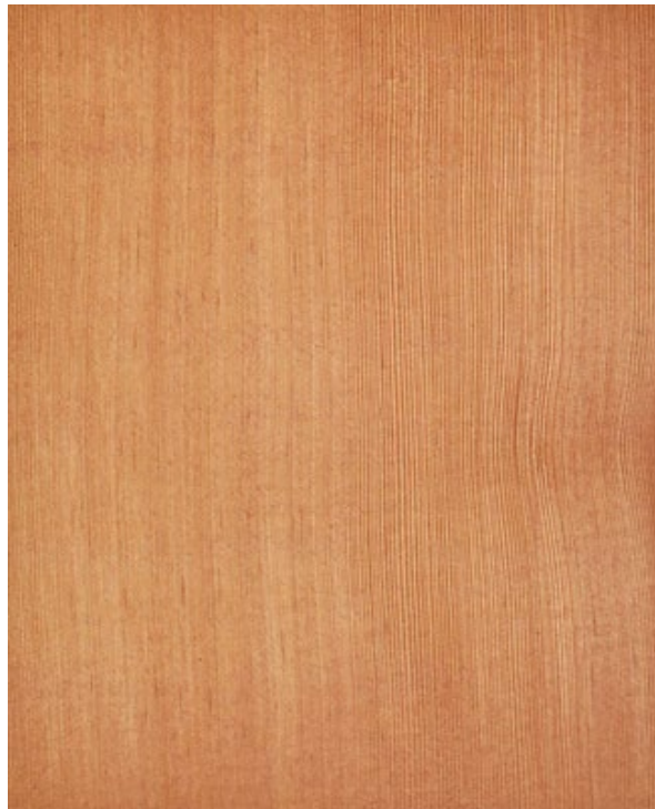
Holzoberfläche von Douglasie (Radialschnitt) beste Wuchsqualität vom Naturstandort USA
