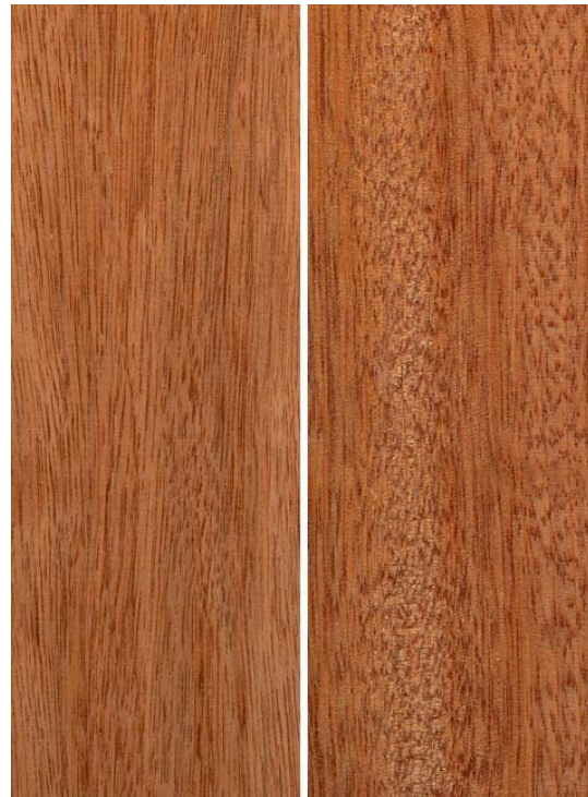
Holzoberfläche von Bintangor (Radialschnitt)
