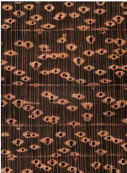
Makroskopischer Querschnitt von Afzelia (10-fache Lupenvergrößerung)
