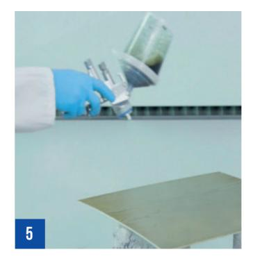
Nach 4 Stunden Trocknung bei Raumtemperatur, kann die Beize mit einer Spritzpistole im Kreuzgang aufgetragen werden.
