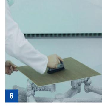
Oberfläche anschliessend mit einer Beizbürste oder einem saugfähigen Tuch gleichmässig abreiben.
