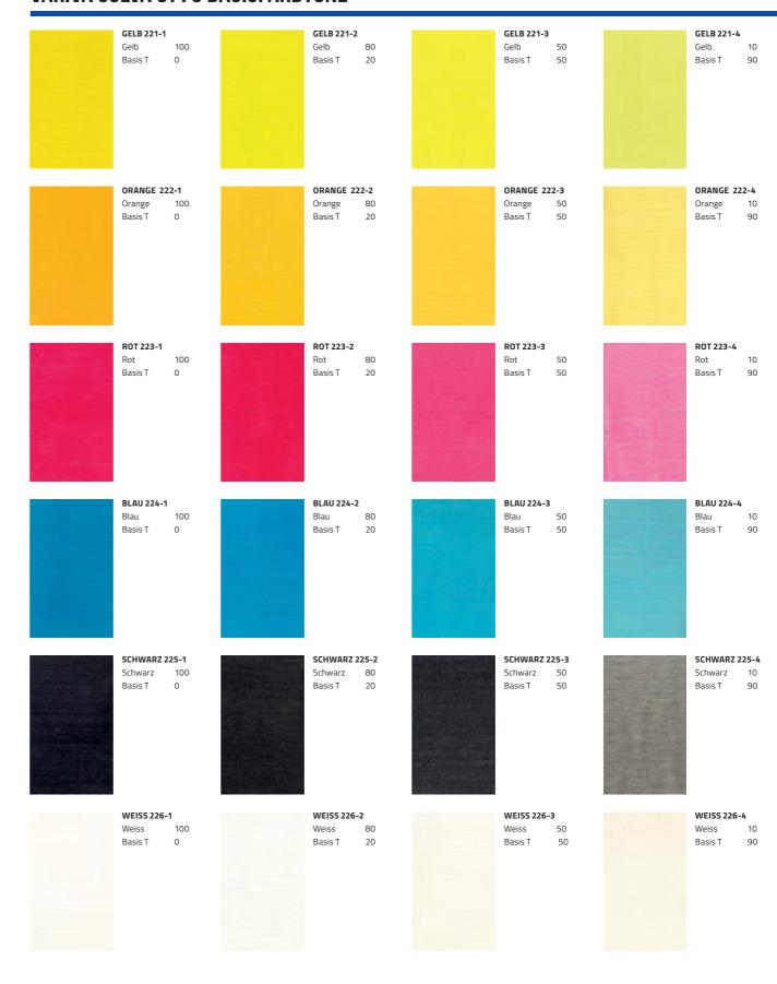
1x mit 40 g/m2 appliziert auf Ahorn und überlackiert mit SUPREMO KLARLACK 3990-15. Alle vorliegenden Farb- und Effektmuster dienen als Orientierungshilfe. Die entsprechende Beize kann auf Grund von Unterschieden in Holz, Schliff, Beizauftrag und/oder eingesetztem Lackmaterial zu abweichenden Resultaten führen.
