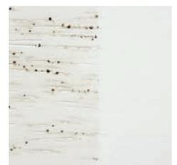
▲ Links wurden herkömmliche Beschichtungsprodukte benutzt, während das Holz rechts mit Teknos' Antibleed Grundierung behandelt wurde. Erfüllen Sie die hohen Ansprüche an Oberflächenfinish, die heute gestellt werden. ▼
