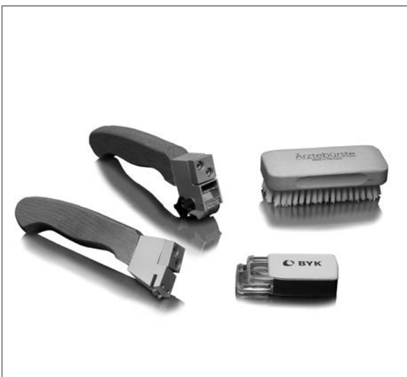
Kuva 8.4 Hilaristikkolaite, jolla maalikalvon tarttuvuus voidaan testata ISO 2409 standardin mukaisesti.
