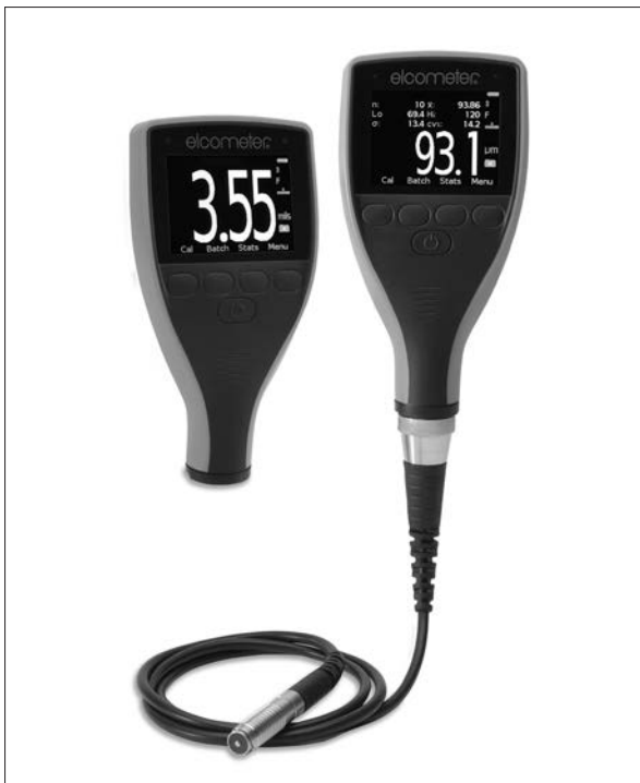
Kuva 7.12a Kuivakalvonpaksuusmittaria käytetään standardien ISO 1461, ISO 19840, ISO 2063, ISO 2360, ISO 2808-7C, ISO 2808-7D ja ISO 2808-12 mukaiseen testaukseen.
