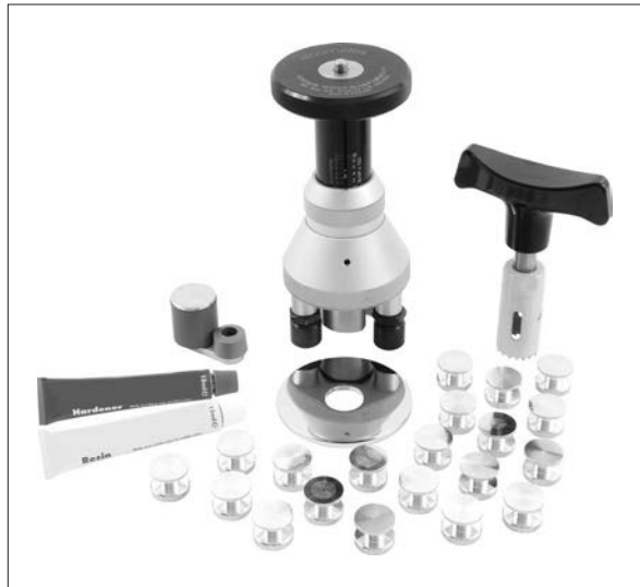
Kuva 8.3 Adheesiotesteri, jolla mitataan maalikalvon tarttuvuutta ns. vetokelella standardien ISO 4624 ja ISO 16276-1 mukaisesti.
