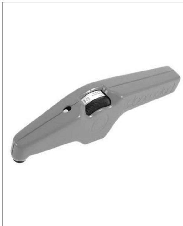
Kuva 7.12b Kestomagneettiin perustuvaa irtivetoperaatteella toimivaa kalvonpaksuusmittaria käytetään räjähdysriskillä työmailla, kuten öljynpora-autoilla, jalostamoissa, yms. Mittari tunnetaan myös nimellä banaani ja se soveltuu standardien ISO 2178 ja ISO 2808-7A mukaiseen testaukseen.
