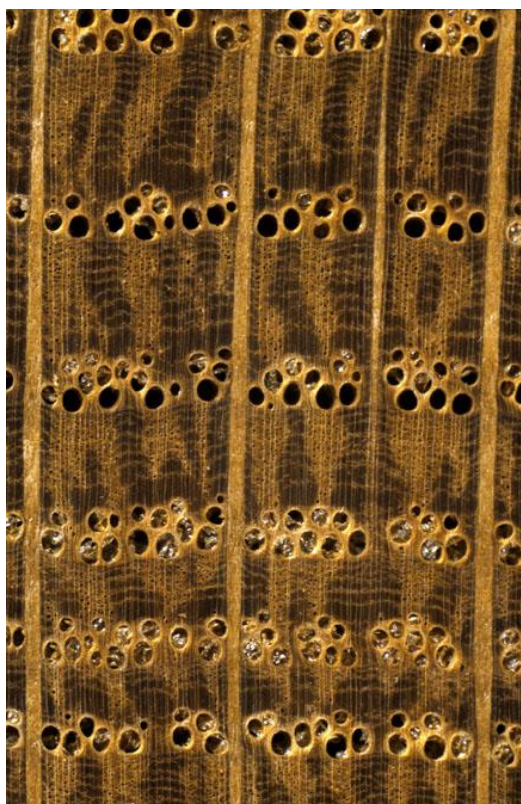
Makroskopowy przekrój białego dębu (10 x powiększenie)
