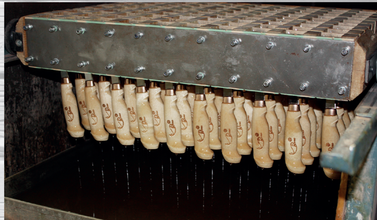
PUUKONKAHVAT SAAVAT PINTAANSA TEKNOKSEN KIILTÄVÄN TEKNOCOAT 1687-58 LAKAN.
