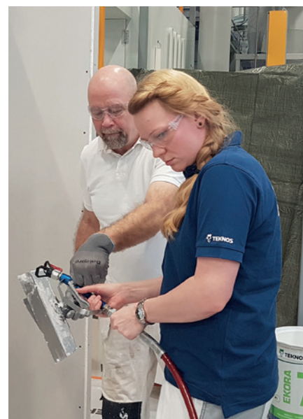
HÄKAN SÖDERBLOM SCANPACILTA OPASTAA TEKNOKSEN TEKNISTÄ NEUVOJAA SUSANNA KAATEIKKOA CURA-TASOITERUISKUN KÄYTTÖÖN.
