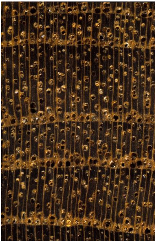
Makroskopisk tværsnit af Teak (10x forstørrelse)
