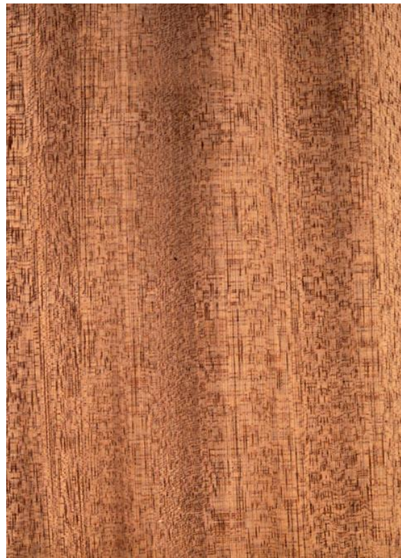
Overflade på Sipo (radiært snit)
