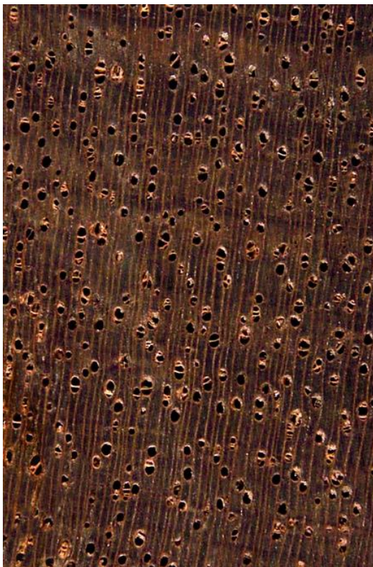
Makroskopisk tværsnit af Mengulang (10x forstørrelse)
