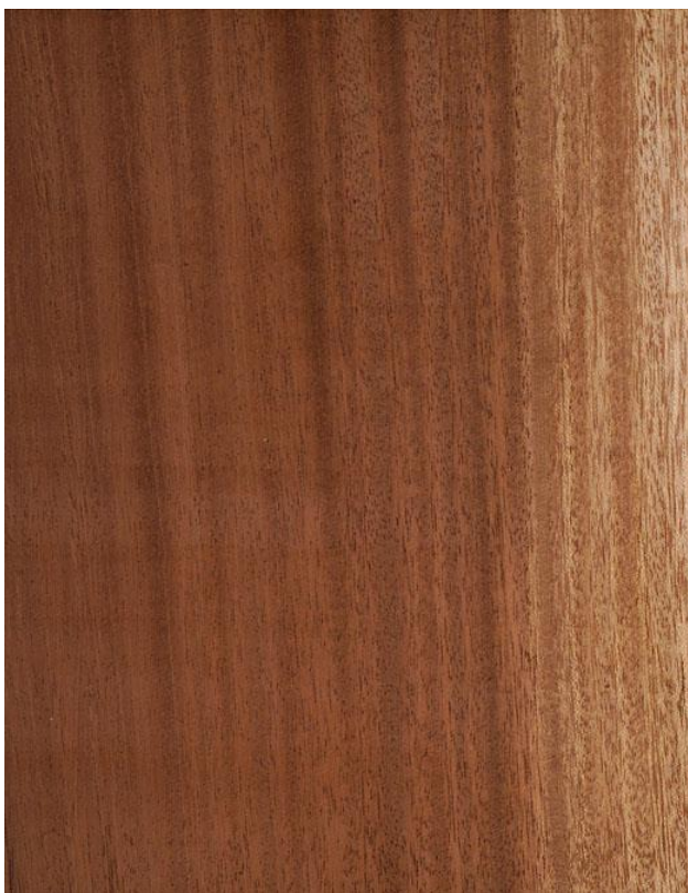
Overflade på Khaya (radiært snit)
