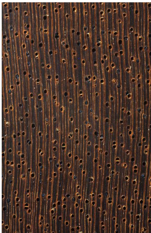
Makroskopisk tværsnit af Khaya (10x forstørrelse)
