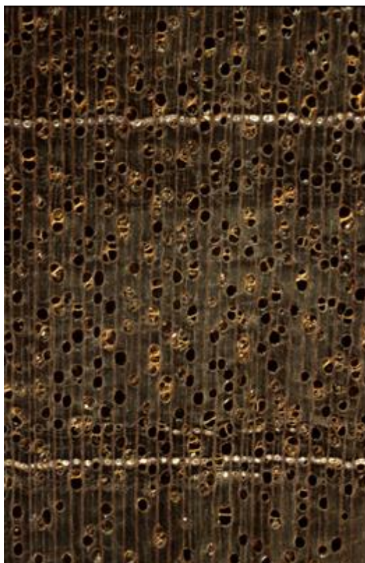
Makroskopisk tværsnit af mørkerød Meranti (10x forstørrelse)
