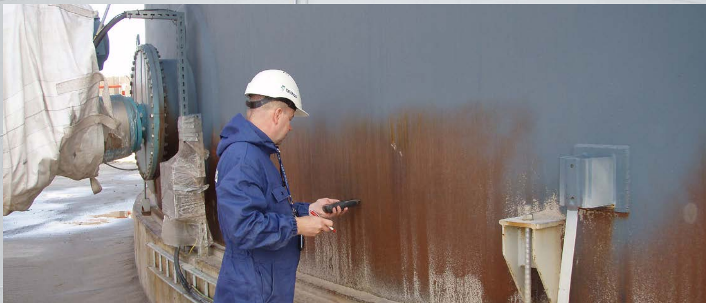
Måling af overfladetemperaturen på væggen af en container.
